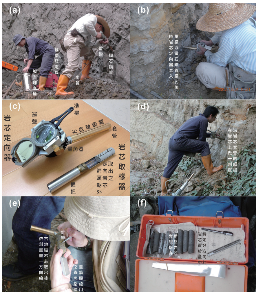
古地磁野外採樣所需的器材與岩芯之定向。(a)以附加有1英寸直徑鑽石鑽管的電鑽在岩層中鑽取岩芯，於鑽孔期間將加壓唧水桶內的水注入鑽管中，以便將粉塵以泥漿帶出。(b)電鑽鑽孔後，將岩芯定向器的套管套入鑽孔中。(c)將岩芯定向器上之羅盤內水平氣泡調整至水平，並使準星對準套管上的方向線細縫，此時可記錄下準星線與指北針所夾的方位角，另外藉由量角器記錄下套管與水平面所夾的傾斜角。(d)沿套管細縫在岩芯上做一刻畫標記。(e)移出岩芯定向器，再以岩芯取樣器扳斷鑽孔內的岩芯並取出。根據岩芯上的刻畫標記畫下一完整的方向線。(f)將定好方向的岩芯置於樣本盒中，若岩芯發生斷裂則以套袋保存。
